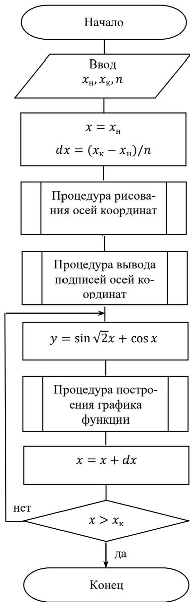
Рис. 5. Блок-схема алгоритма построения графика функции
